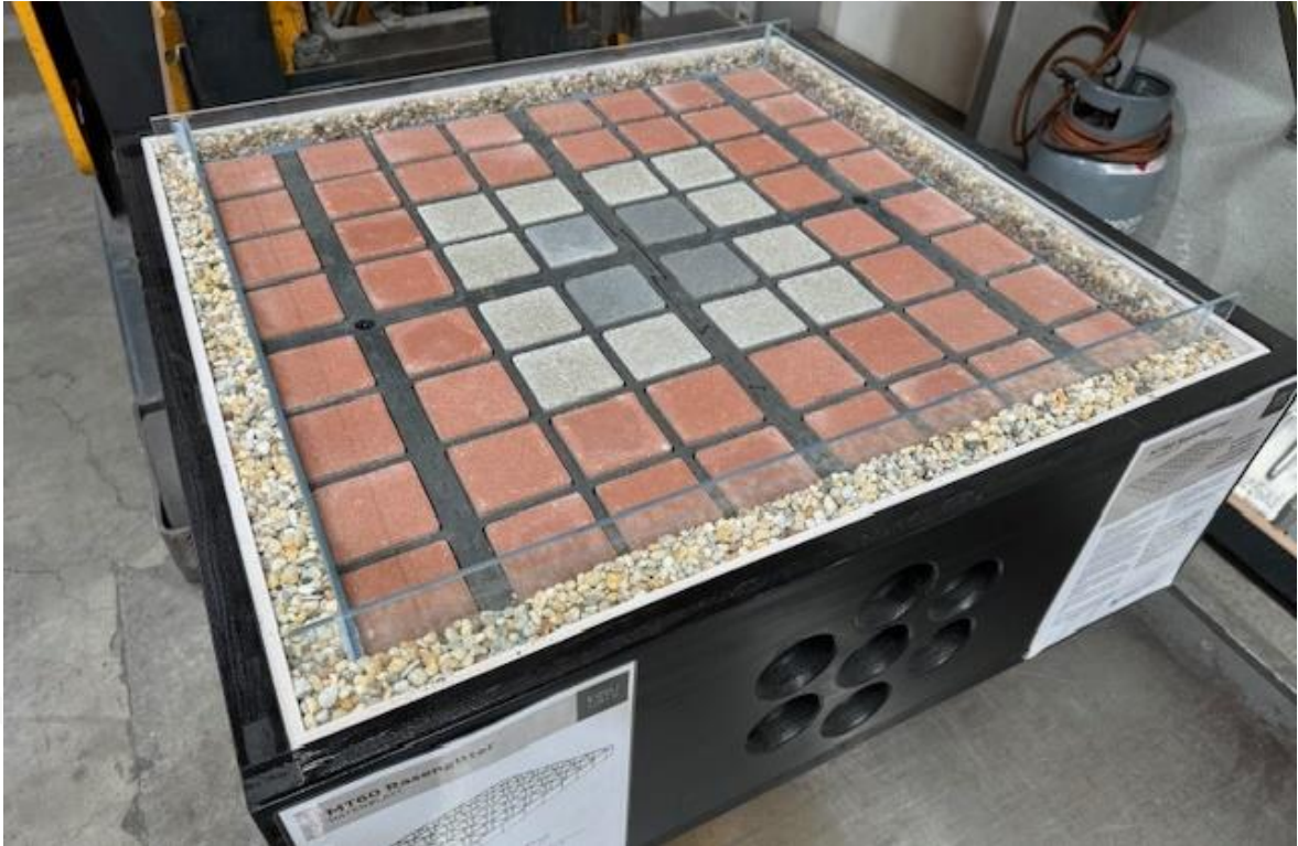
Abbildung 1: bereitgestellte Prüfbox mit steingefülltem Kunststoffgitter
